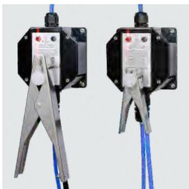
Le stazioni di indicazione esterne, energeticamente efficienti, di **Earth-Rite MULTIPOINT II**, offrono l'indicazione dello stato della messa a terra di ogni canale. L'appariscente LED VERDE lampeggia continuamente quando un collegamento a terra positivo viene effettuato. Le stazioni di indicazione possono essere montate in tutte le zone ATEX/IECEX e in tutte le aree pericolose Classe e Divisione. Oltre all'opzione GRP standard, è possibile specificare stazioni di indicazione in acciaio inox.
