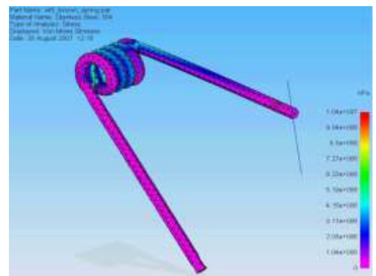
Le molle di Newson Gale sono progettate e analizzate con l'aiuto della tecnologia dell'analisi degli elementi finiti.
