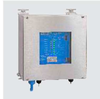
L'unità di monitoraggio Earth-Rite MULTIPOINT II contiene 8 coppie di indicatori a LED (rossi e verdi) della messa a terra. L'unità può essere montata in tutte le zone ATEX/IECEx e in tutte le aree pericolose Classe e Divisione.
