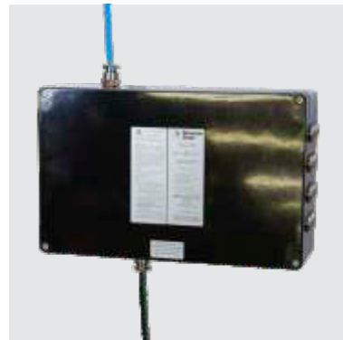
L'unità di alimentazione di 230V/110V CA di Earth-Rite MULTIPOINT II è dotata di undici (11) contatti potenziale zero SP/DT. Otto di questi contatti si interfacciano con ogni canale di messa a terra monitorato; 2 offrono la funzione di canale raggruppo e 1 relè fornisce la funzione di uscita di ridondanza fail-safe. L'unità di alimentazione può essere installata nelle Zone 2/21 e nelle aree Classe I, Div.2, Classe II, Div.1 e Classe III, Div.1. L'alimentatore può essere alloggiato in involucri in vetroresina (GRP) o in acciaio inox.
